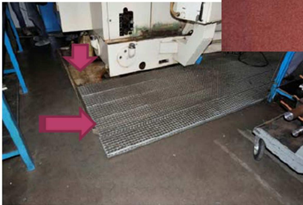
Lavorazione metalli, possibile presenza di olio sul pavimento
