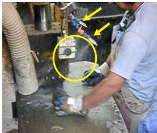
*Abbattimento di polveri ad elevato contenuto di silice nella lavorazione a spacco del porfido con aerosol d'acqua*
