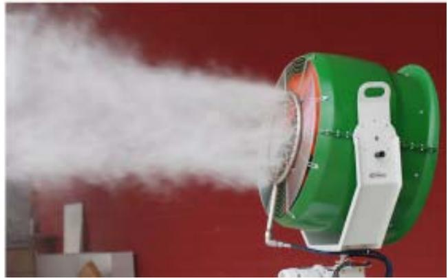
*Generatore di aerosol ventilato in funzione*
