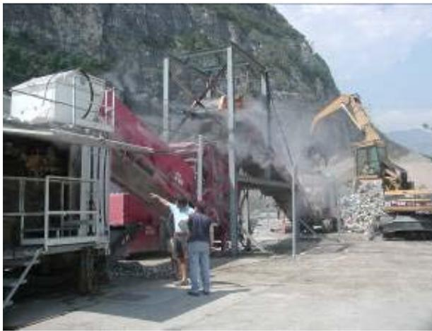
*Esempio di applicazione di aerosol d'acqua per l'abbattimento di polveri in un impianto di compattazione di rifiuti solidi urbani*
