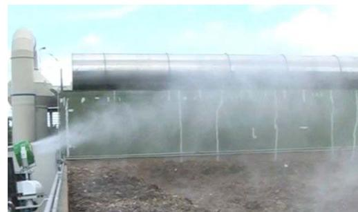
*Esempio di utilizzo di aerosol ventilato in una discarica di materiali organici per la riduzione delle polveri e degli odori dispersi*
