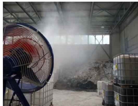
*Esempio di applicazione di aerosol ventilato in un capannone di stoccaggio di rifiuti speciali*
