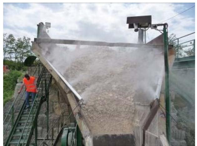
*Esempio di abbattimento delle polveri su una tramoggia di carico di un vaglio per materiali inerti con aerosol d'acqua*
