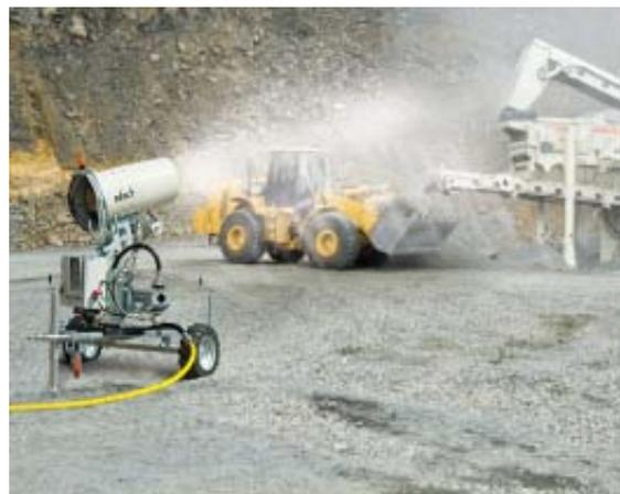
*Generatori di aerosol ventilato in cava di inerti*
