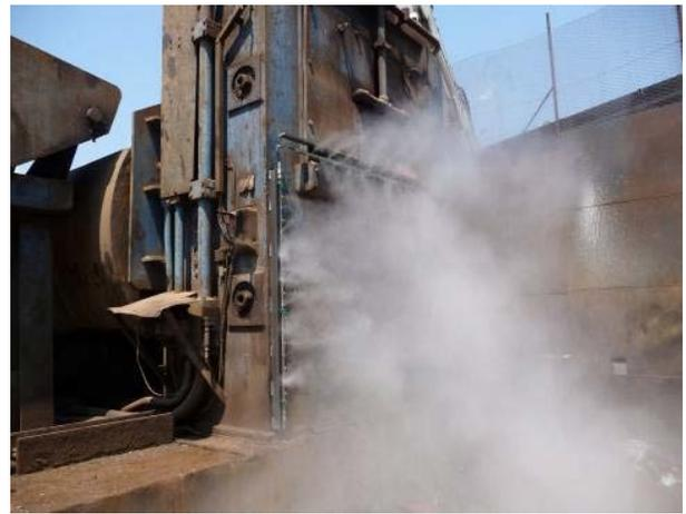
*Esempio di applicazione di aerosol d'acqua su una pressa in un'azienda di riciclo di materiali ferrosi*
