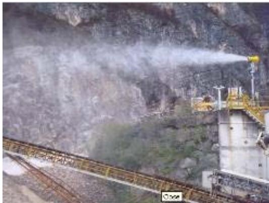
*Esempio di applicazione di aerosol ventilato in un impianto di frantumazione di materiali lapidei*
